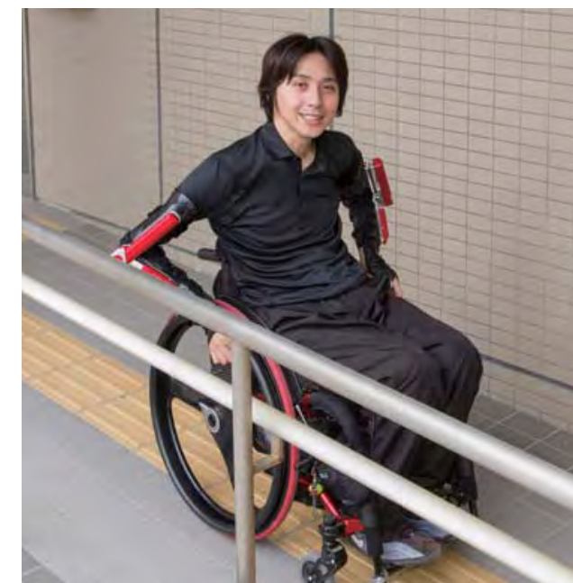
上肢動作支援ロボット（アクティブギプス）による車いす操作支援
